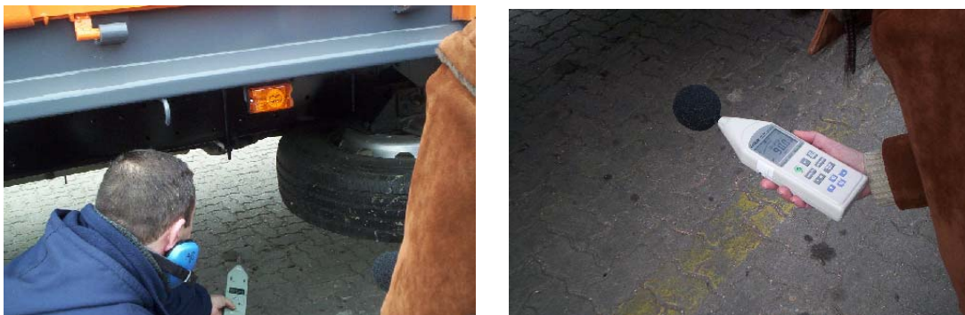
Figura 1 a y b. Toma de niveles sonoros por operarios de SUCTA.
